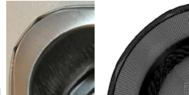
Diffygion yng nghornel (a) y cynhwysydd bwyd alwminiwm a weithgynhyrchwyd a (b) y model cyfrifiadurol
