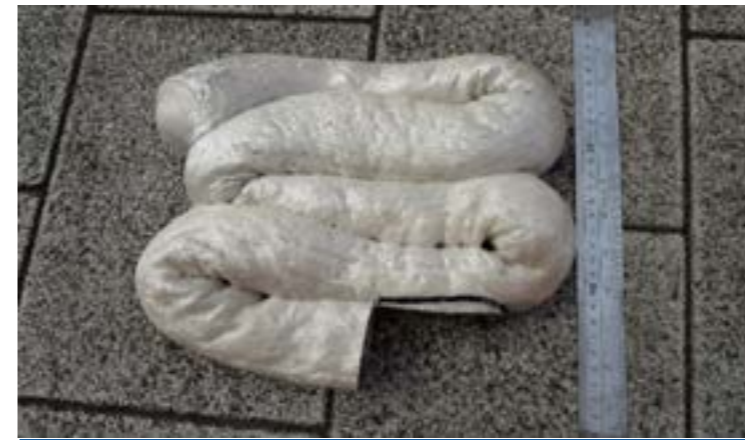
EPS a ddwysawyd gan ddefnyddio cywasgu mecanyddol a gwres
