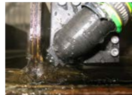
Delwedd: Mae'r chwythell ddŵr yn helpu i drosglwyddo'r signal i arwyneb y darn sy'n cael ei brofi, ac oddi yno.
