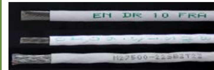
Enghreifftiau o wifrau a cheblau manyleb gyffredin awyrafod ar ôl stripio â laser ar y paramedrau wedi'u hoptimeiddio y cafwyd hyd iddynt trwy ddadansoddi.
